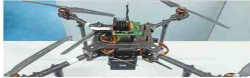
पिलानी ड्रोन में लगा फ्लाइट कंट्रोल सिस्टम पिलानी ड्रोन में लगा फ्लाइट कंट्रोल सिस्टम ड्रोन में लगा फ्लाइट कंट्रोल सिस्टम।
