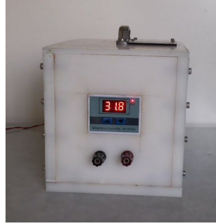
चित्र 2 : थिक फिल्म हॉटप्लेट एकीकृत बैटरी वार्मर
