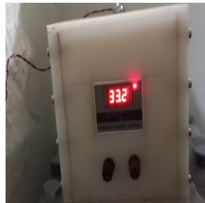
चित्र 3 : कम तापमान में बैटरी वार्मर परीक्षण
