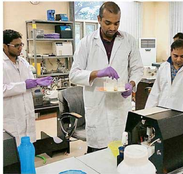
सीरी लेबोरेट्री में दूध में मिलावट की जांच करने वाले उपकरण क्षीर स्कैनर के छोटे रूप क्षीर टेस्टर पर अनुसंधान करते शोधकर्ता।
